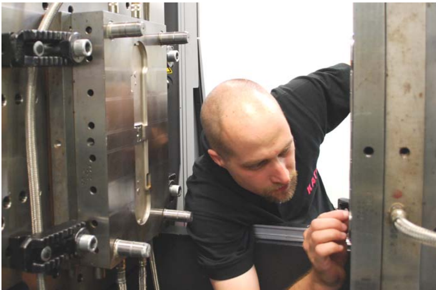
Abbildung 7 Musterung eines Spritzgiesswerkzeuges am KATZ
