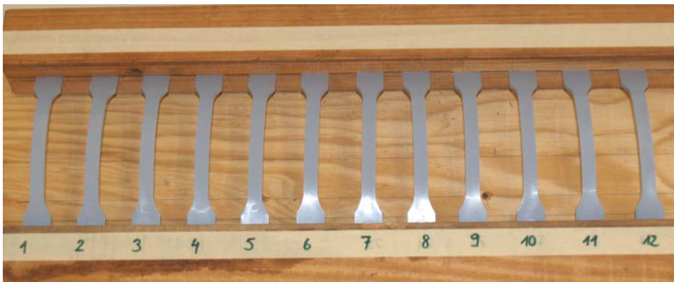
Abbildung 13 Spannungsrisssprüfung an Schulterstäben
