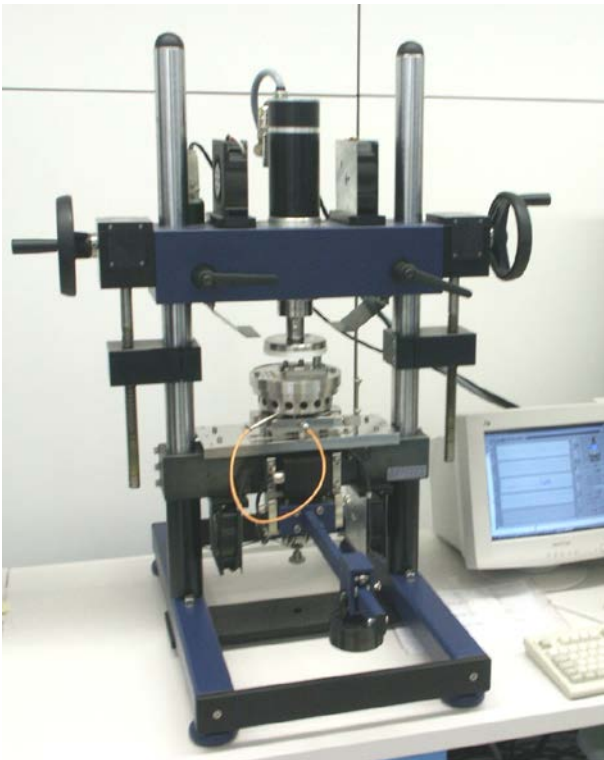
Abbildung 16 Tribometer zur Bestimmung von Reibungs- und Verschleissverhaltens
