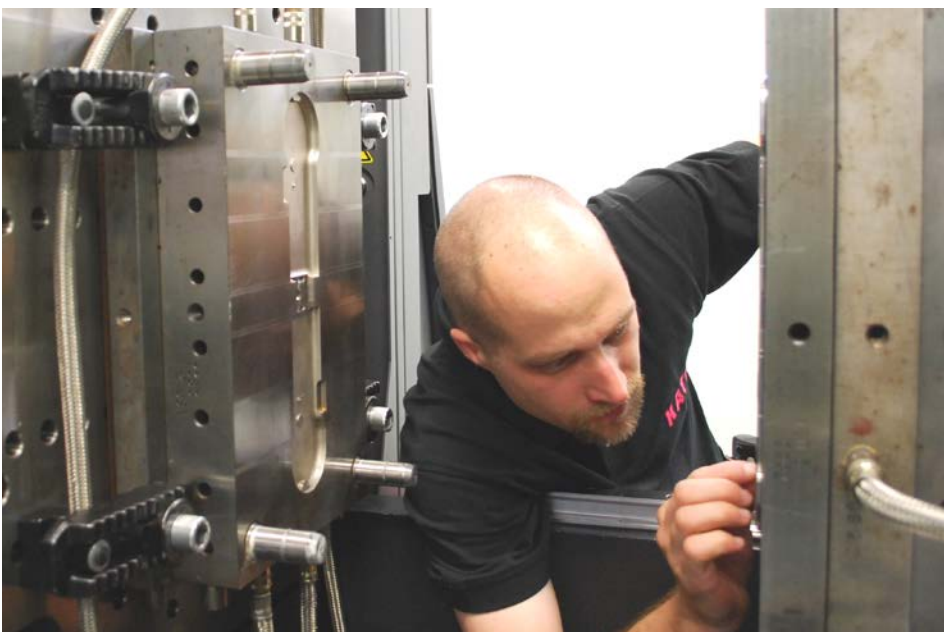
Abbildung 7 Musterung eines Spritzgiesswerkzeuges am KATZ
