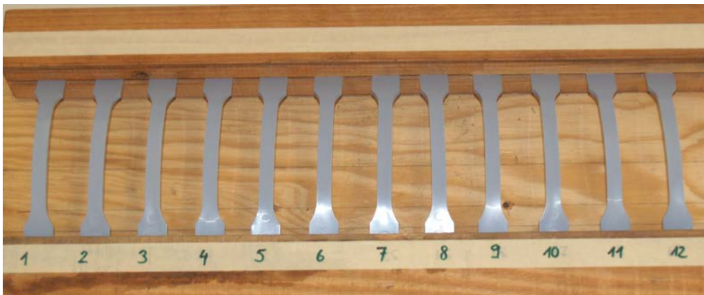
Abbildung 13 Spannungsrisssprüfung an Schulterstäben
