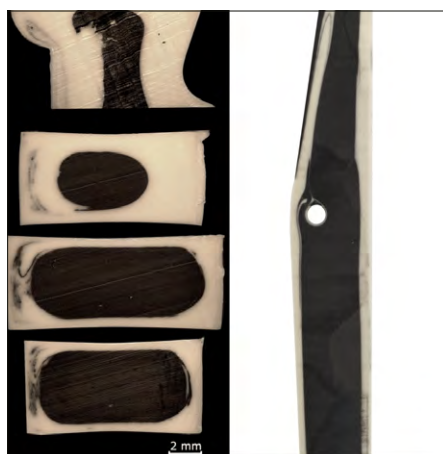
Bild 2: Links: Querschnitte aus Versuch 8. Diese wurden gleichmässig entlang des Hebels entnommen. Dabei sind die unteren Querschnitte Angussnah. Rechts: Längsschnitt aus Versuch 3.
