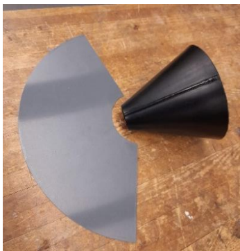
Praktische Arbeit «Apparatebau» am Beispiel eines Trichters
