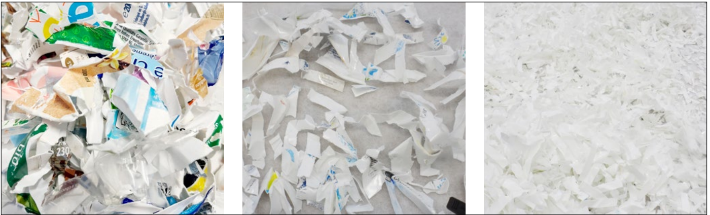
Bild 3: Flakes vor dem Waschen (links), und nach dem Waschen, mit Restfarbe (Mitte), und vollständig deinkt (rechts). (Bild: realcycle GmbH)
